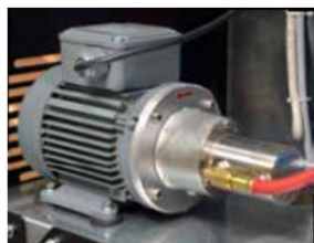
POMPA AD INGRANAGGI Per il riempimento veloce del refrigerante (1000 gr / min)
